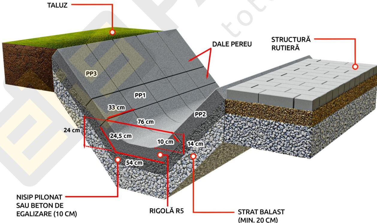
**Etape de execuție:** Se montează rigolele R5, R6 sau R9 pe un strat de fundație din balast minim 20 cm grosime și un strat de egalizare din nisip sau beton de 10 cm grosime.
