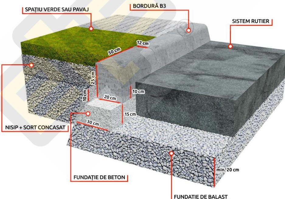
Bordurile se montează conform cotelor și aliniamentelor date în proiect, pe o fundație de beton C12/15 cu secțiunea de minim 15x30 cm, pozată semiuscat și așezată pe infrastructura compactată a obiectivului (drum, platformă).
