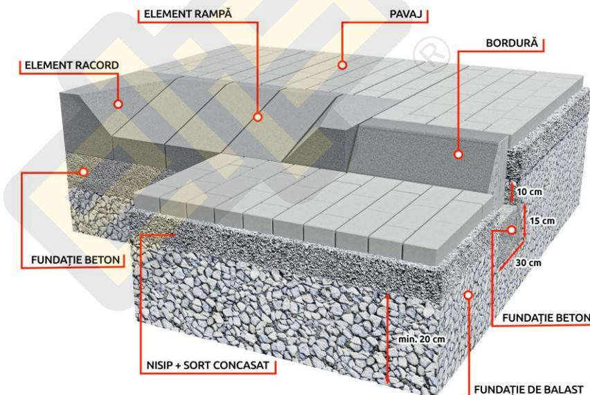
Elementele racord se montează conform cotelor și aliniamentelor date în proiect, pe o fundație de beton C16/20, turnată semiuscat și așezată pe infrastructura compactată a obiectivului (drum, platformă).
